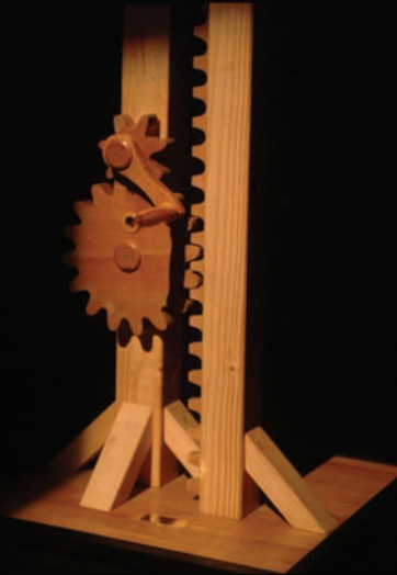
Kriko: Kol yardımıyla döndürülen dişli çark, kendisinden daha büyük olan dişli çarkı döndürüyor, dişler karşılığında yer alan oyukları iterek kolun aşağı yukarı hareketini sağlıyor. Bu düzeneğin günümüzde en basit kullanım alanlarından biri araba krikosu.
