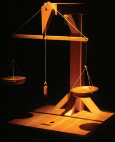
Nemölçer: Terazinin kefelerinden birine pamuk diğerine de eşit ağırlıkta balmumu yerleştiriliyor. Belirli bir süre sonra havadaki nemi emerek ağırlaşan pamuğun yarattığı sapmanın ölçülmesiyle, havadaki nem oranı hakkında bilgi sahibi olunuyor.
